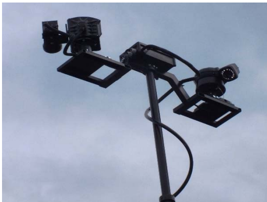
CCTV-System mit Wärmebildkamera VarioCAM® hr head 620
