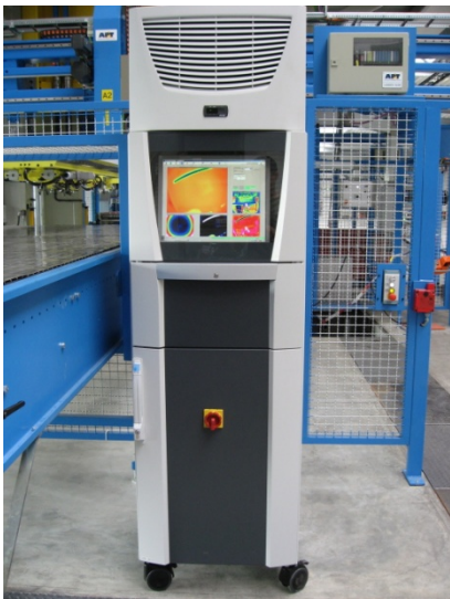
Abb. 1: Steuer- und Auswerteeinheit zur Bedienung der Kamera an der Presse und Übermittlung der Auswertung an die Pressensteuerung
